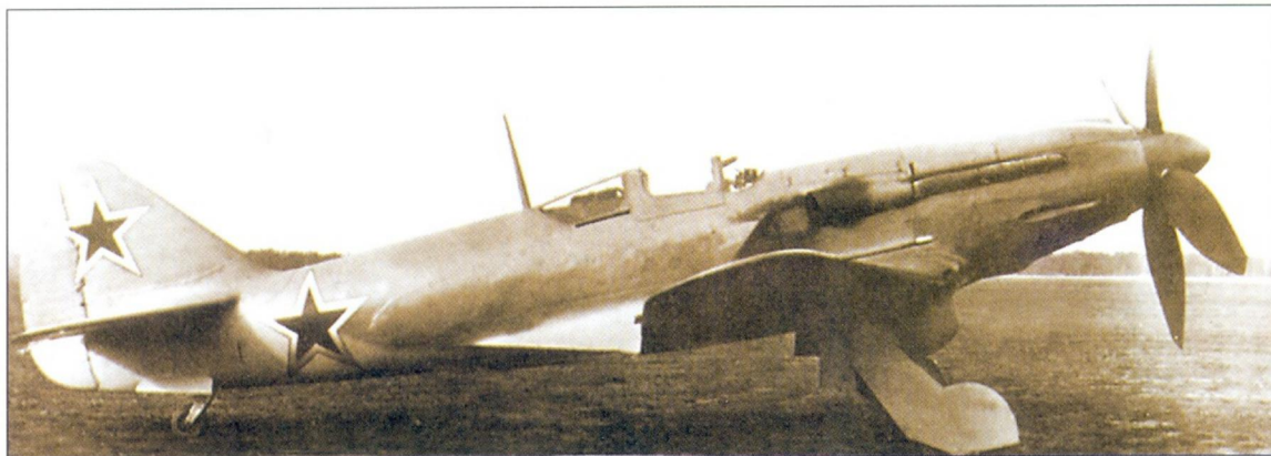
Опытный И-224 развивал скорость до 700 км/ч и поднимался на высоту 14 км
