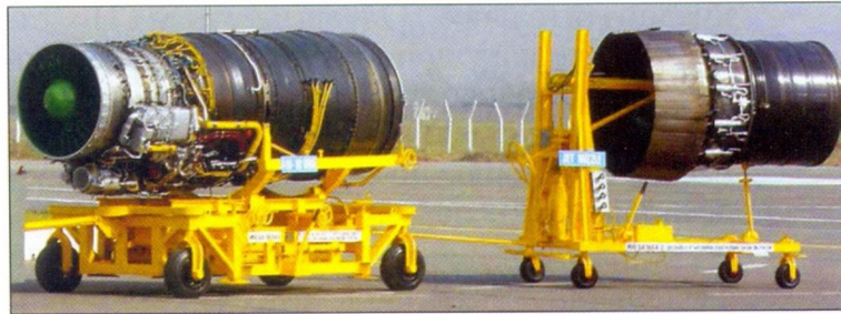
Уникальный двигатель Р15-300, стоявший на Е-152, а позже на МиГ-25
