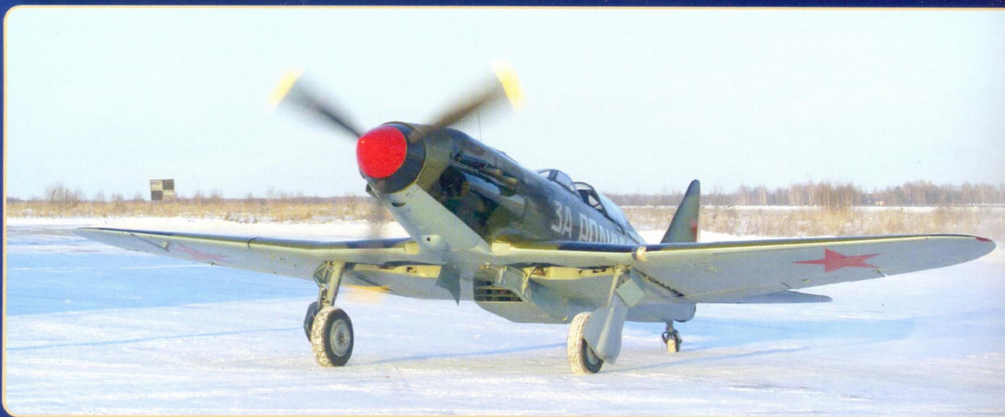
Истребитель МиГ-3, восстановленный компанией «Авиареставрация» из Новосибирска на основе оригинальных чертежей с использованием отдельных элементов, оставшихся от подлинных самолетов.
