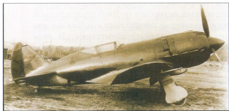
Опытный МиГ-3 с двигателем воздушного охлаждения М-82. Осень 1941 г.
