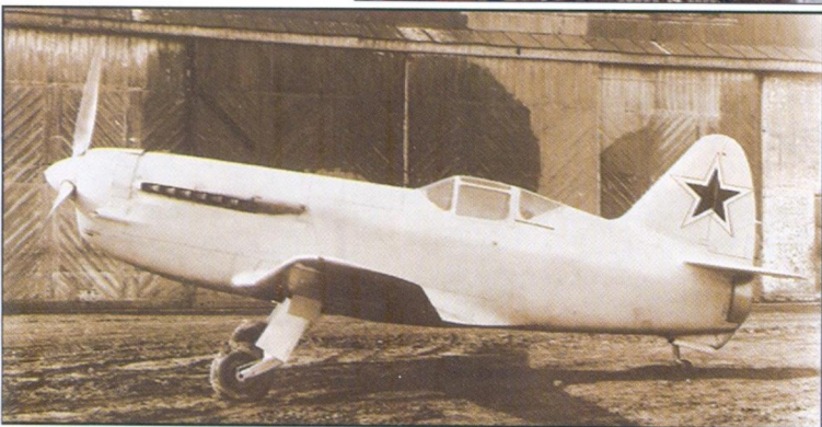
Истребитель И-250 с поршневым и реактивным двигателями
