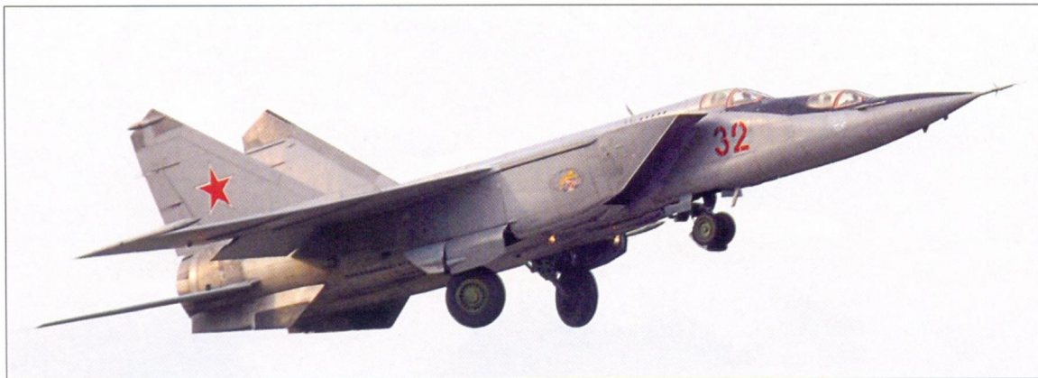
Учебный двухместный МиГ-25У отличался необычным размещением двух отдельных кабин
